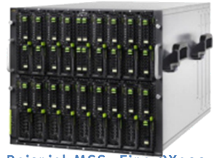
Beispiel MSS: Eine BX900 der Firma Fujitsu Technology Solution GmbH
