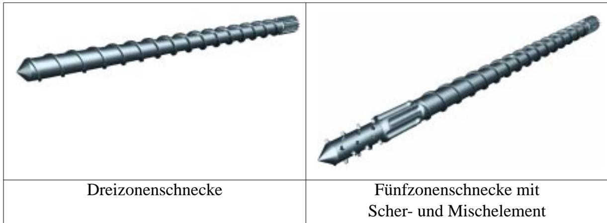
Abbildung 3 Mit REX bzw. PSI simulierte Schnecken geometrien
